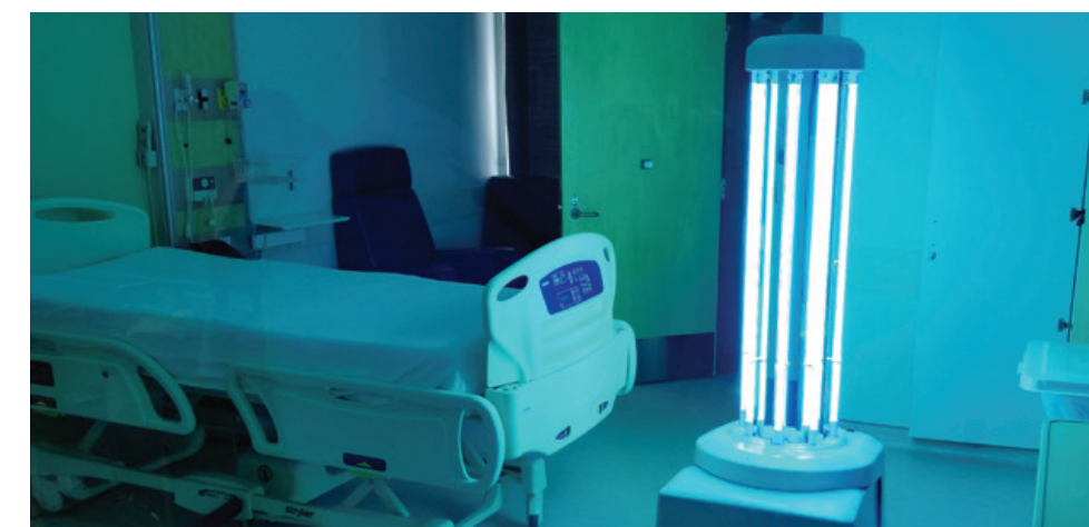
La stérilisation d'une salle est un processus à forte intensité de main-d'œuvre prenant des heures, mais le robot de désinfection par UV peut le faire en une fraction de temps, évitant ainsi un risque d'infection pour le personnel d'entretien.
