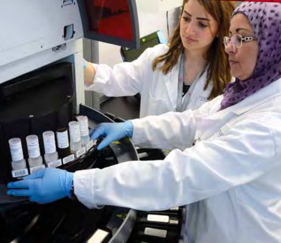
Traitement des lames d'histologie : Tiba Hijazi et Fazila Chouiali effectuent le chargement du système robotisé pour le marquage des lames. Histology slide processing: Tiba Hijazi and Fazila Chouiali load the automated slide staining system.
