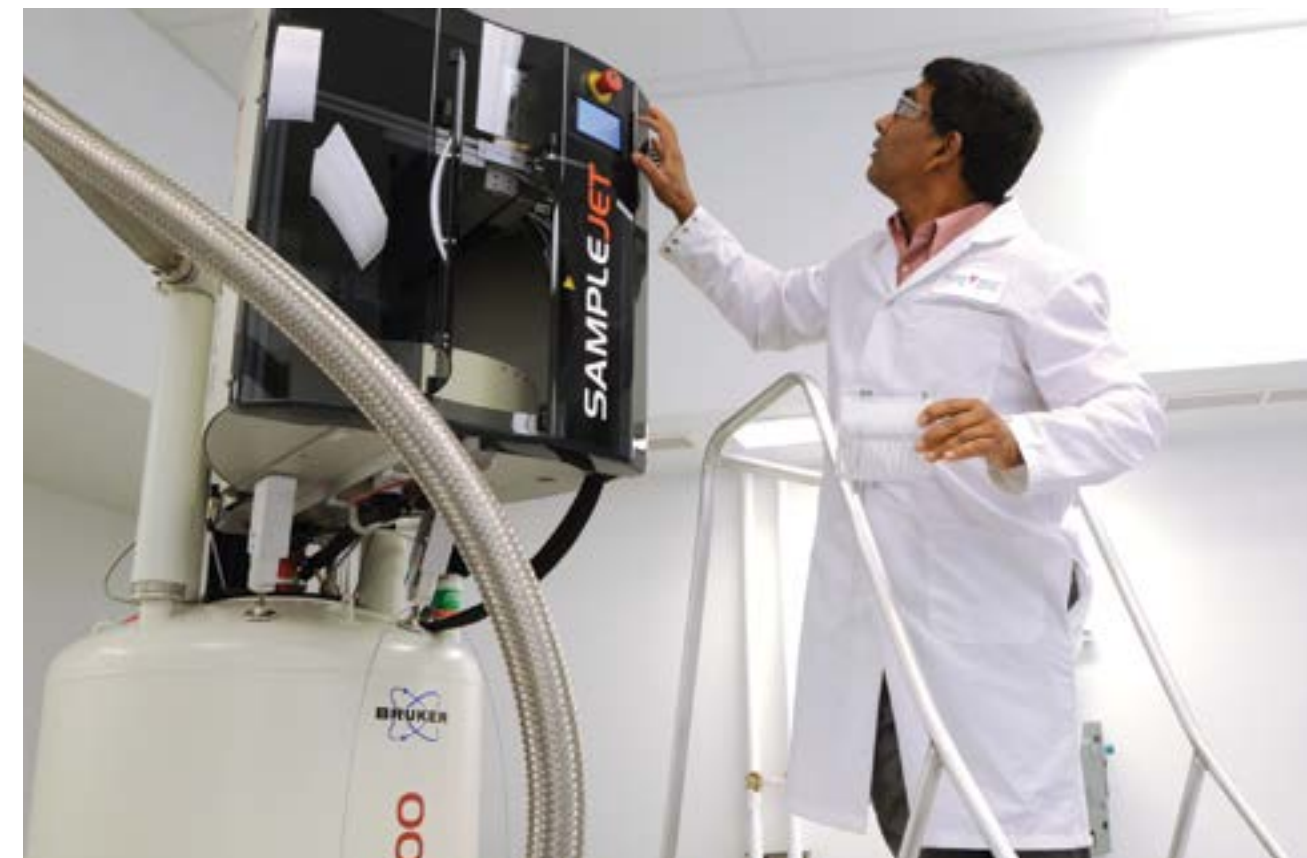
■ Le Dr Sanjoy Das dépose un échantillon pour une analyse de résonance magnétique nucléaire. ■ Dr. Sanjoy Das loads a sample for nuclear magnetic resonance analysis.
